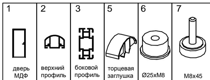
1. Установить в боковые профили втулки (6) и опоры M8x45 (рис.1).
