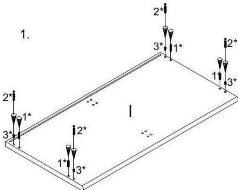
В отверстия, соответствующие отверстиям в верхних торцах боковин шкафов, забить шканты (1) и цанговые футорки (5) (рис.1). В футорки вкрутить дюбеля стяжек-эксцентриков (6) до упора в обод (рис.1).
