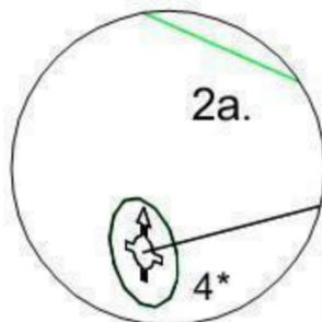
В глухие отверстия Ø15 мм, на внутренней стороне боковин шкафов, вставить стяжки-эксцентрики (4) стрелкой в направлении отверстий на торцах (рис. 2, 2а).
